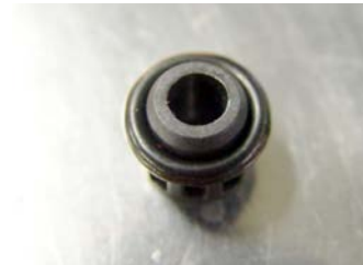
O-Ring in korrekter Position
