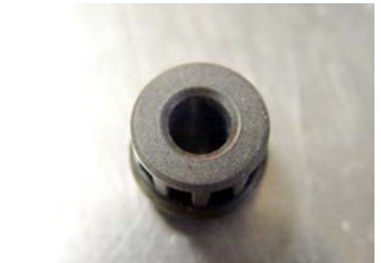
O-Ring in falscher Position
