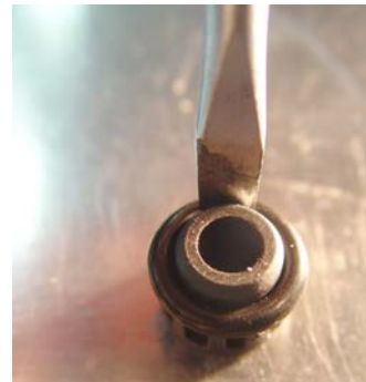
O-Ring in korrekter Position
