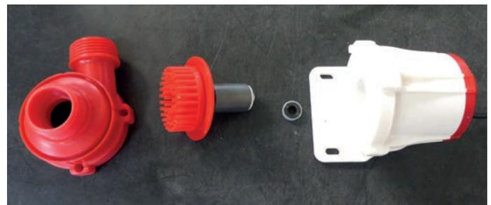
Bitte greifen Sie mit den Fingern hinter das Dispergatorrad und ziehen Sie das Laufrad mit einem sanften Ruck aus seiner Spalttopfführung. Reinigen Sie das Laufrad, mit einem spitzen, glatten Gegenstand, wie z. B. eine Nagelfeile oder Ähnlichem.
