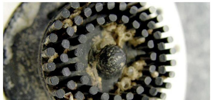
Bitte entkalken Sie nun die Läufergruppe mit einem geeigneten Entkalkungsmittel.
