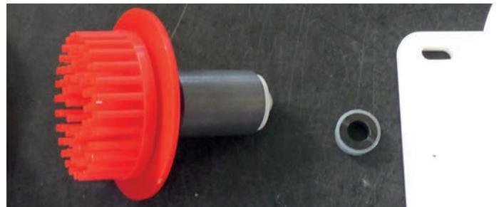
Sollte die hintere Lagerbuchse beim Herausziehen der Läufergruppe auf der Welle sitzen, so ist das Lager unbedingt von der Welle zu entfernen. *Bild oben: Lagerbuchse nach dem Ablösen von der Welle. So sollte diese auch wieder eingesetzt werden.*
