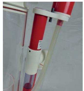
Am rotem Keilrohr und am weißen T-Stück, befindet sich jeweils eine kleine Markierung. Diese dient zur Orientierungshilfe für die Einstellung des Keilrohres.
